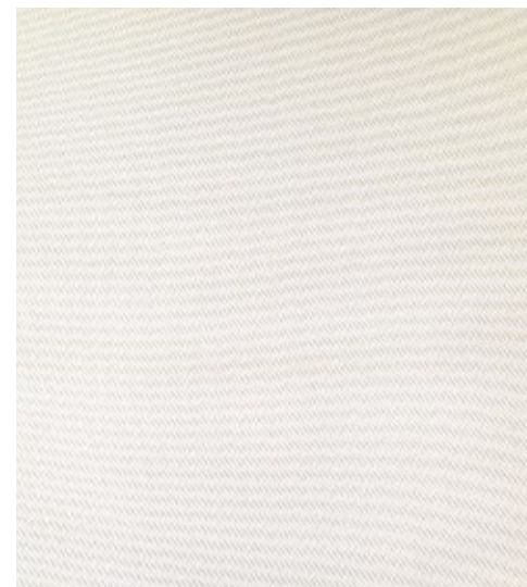
SCREEN 1% WHITE LARG. 2,00 E 2,50 MTS 30% POLIÉSTER / 65% PVC 5% FIBRA DE VIDRO / 90% PROTEÇÃO UV
